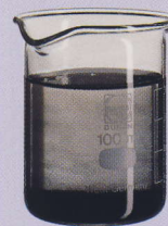
Znečištěná voda ze starého topného zařízení
